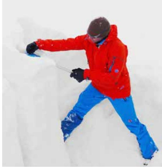
Mit dem Säulen-Test lässt sich die Stabilität der Schneedecke feststellen.
