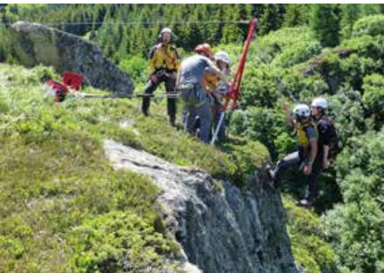
Eine «verunfallte» Person wird mithilfe des Zweibeins aus einer senkrechten Felswand geborgen.
