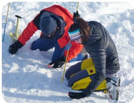
Feinortung mit dem Lawinenverschütteten-Suchgerät: Sonde und Schaufel gehören zur Standardausrüstung der Kameradenrettung.
