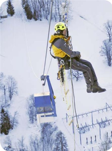
*Ein Retter wird mit einem 1000-m-Statikseil zur blockierten Kabine abgelassen.*
