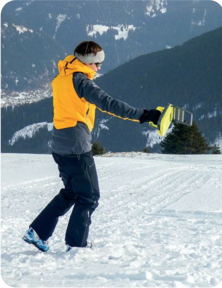
Das nach dem Echolot-Prinzip arbeitende Recco-Suchgerät kommt ausschliesslich bei der organisierten Rettung zum Einsatz.
